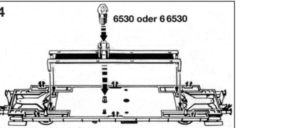
Glühlampe in die Innenbeleuchtung einsetzen.
